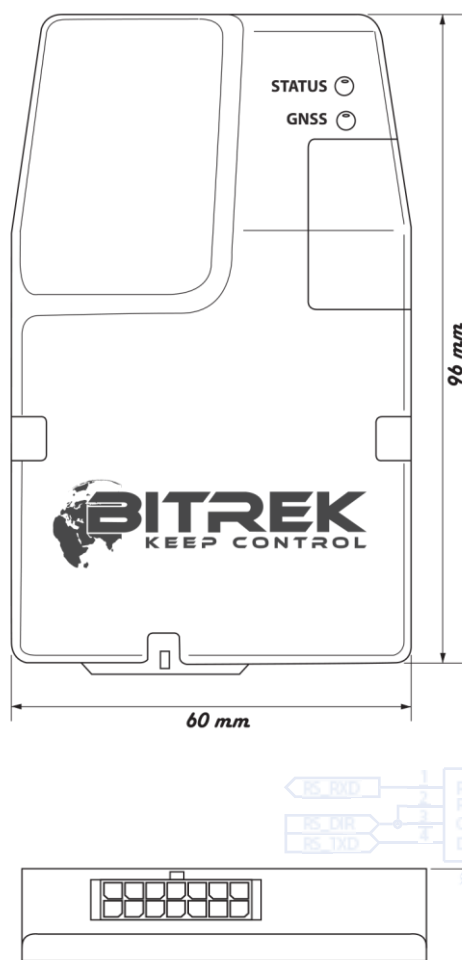
Рис 1. Внешний вид и конструкция устройства.
