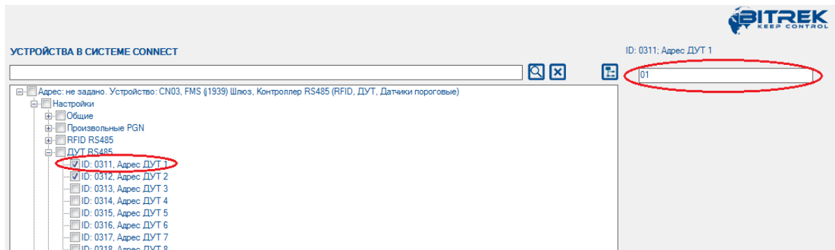
Рис.7. Назначение адреса датчика уровня топлива
