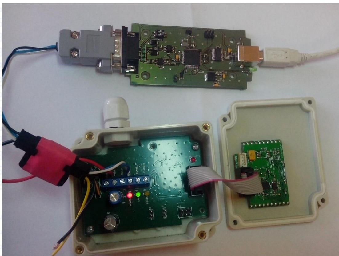
После подключения BLE программатора и соединения CAN\_H и CAN\_L включаем питание на BLE идентификаторе.
