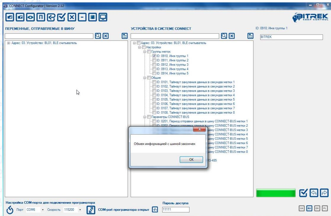
**Для изменения настроек BLE метки прицепного оборудования используем только программу COM-Sender и BLE программатор**
