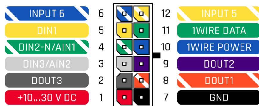
Рисунок 1 FMU130 2x6 распиновка розетки
